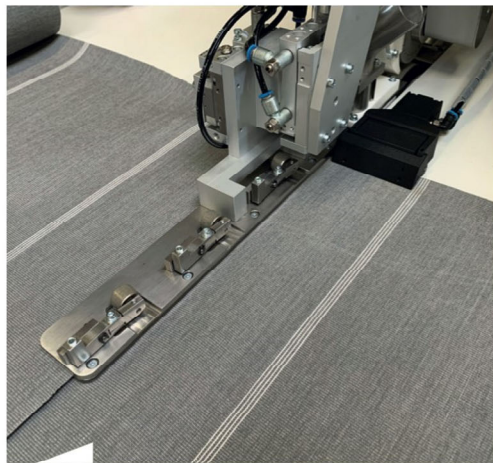
Mit einem speziellen Führungsautomaten werden die Gewebepahnen für die Stoßnaht zusammengeführt und mit einem speziellen Klebeband verklebt. Die Jentschmann-Anlage kann Stoßnähte als auch Überlappungsnähte verarbeiten.
